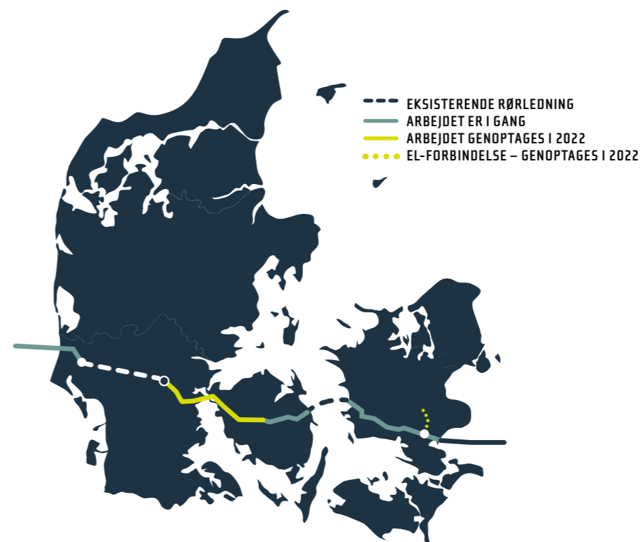
FOTO 2: Baltic Pipe er et kæmpemæssigt ledningsnet på 800-950 km, som skal gå fra de norske gasfelter i Nordsøen gennem Danmark og videre til Polen. Kilde: www.baltic-pipe.eu
